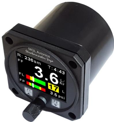
**FF-4:** Computador de Combustível, com monitoração para até dois níveis de combustível, dois sensores de fluxo de combustível e um sensor de pressão de combustível. Mostra tempo e alcance de combustível, podendo receber dados de um GPS via porta NMEA. Inclui alarme configurável para nível mínimo de combustível e pode utilizar tanto o sensor da MGL Avionics, como ser configurado para outros tipos de sensores existentes no mercado.
