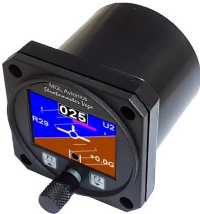
**AHRS-1 (Horizonte Artificial):** É um sistema de referência de atitude de voo, que apresenta os eixos de rolagem (inclinação lateral da aeronave) e arfagem (elevação do ângulo de nariz da aeronave). Este conjunto é baseado no sensor de atitude de voo **SP-7**. Pode ser configurado para apresentar um horizonte artificial ou um coordenador de curva, conectando duas unidades **AHRS-2** ao mesmo **SP-7** e obteremos ambas as funções disponíveis no painel da aeronave como sistemas independentes.
