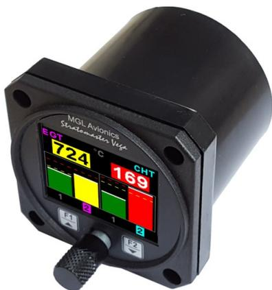
**TC-4:** Sistema para monitoração de até quatro canais de termopares (tipos J, K e E) para EGT'S e/ou CHT'S. Permite 6 tipos de visualização configuráveis, com sistema gráfico para ajuste de mistura, podendo ser utilizado para monitoração de temperatura de motores de pequeno a grande porte.
