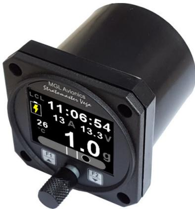
**INFO-1:** Sistema de monitoração de diversos parâmetros: G-Meter (Medidor de força G); Relógio Universal (horário UTC e Local), Cronômetro, Temporizador e Alarme Programável; Coordenador de Curvas (bolinha); Monitor de Bateria (Voltímetro e Amperímetro) com sistema analisador de bateria; OAT (Temperatura Externa); Registros de Voo (Flight LOG).
