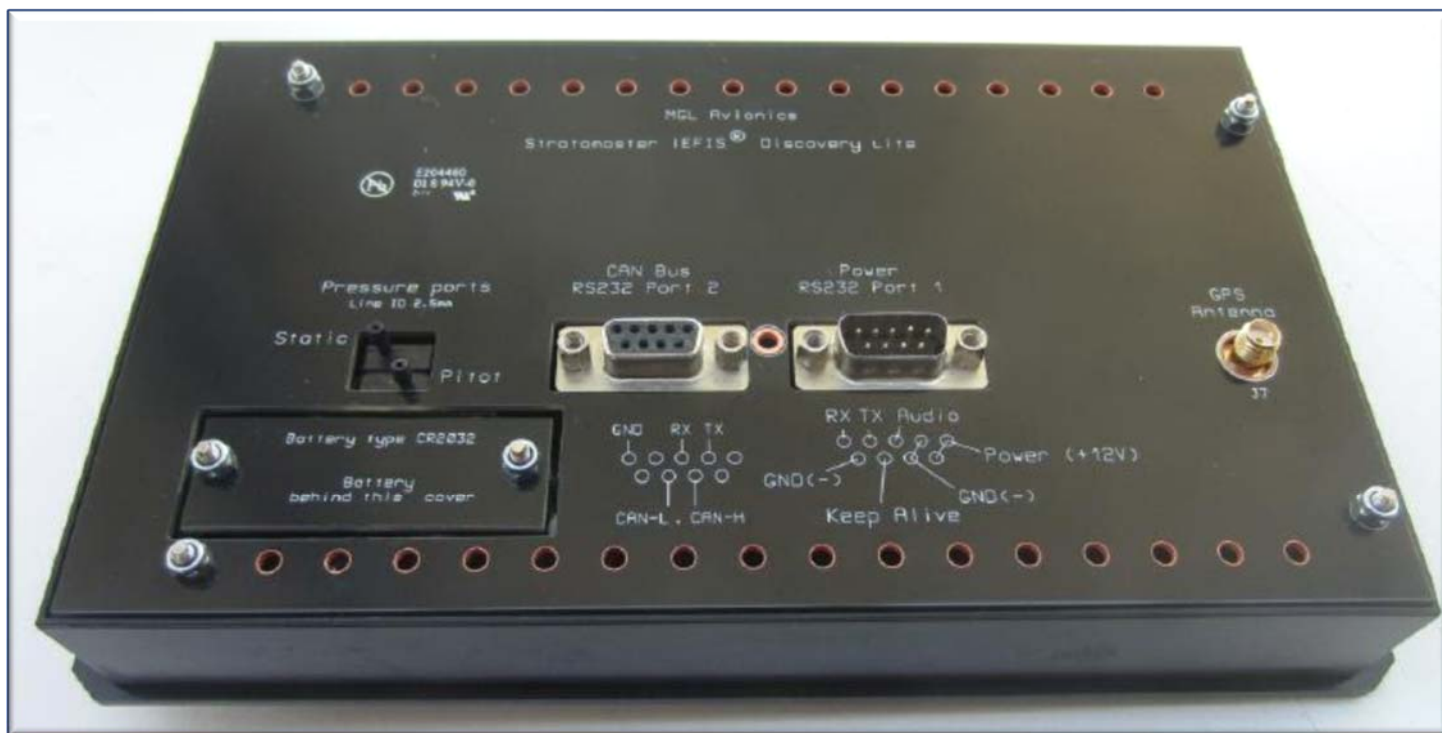
Interfaces no painel traseiro do sistema iEFIS LITE
