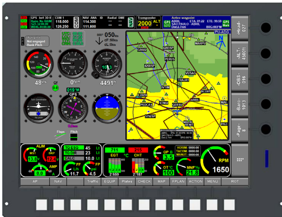
Exemplo de tela iEFIS: simulação de instrumentos analógicos
